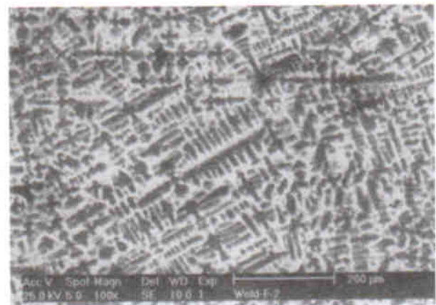
شکل ۸. تصویر میکروسکوپ الکترونی (SEM) ریزساختار جوش Udimet ۵۲۰ شامل دندریت‌های حاصل از انجماد جوش به روش GTAW (۱۰۰۰X).
