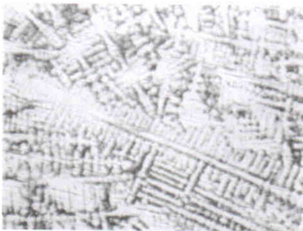
شکل ۶ تصویر میکروسکوپ نوری ریزساختار جوش Udimet ۵۲۰ شامل دندرتی‌های حاصل از انجماد جوش به روش GTAW ( 100\times ).
