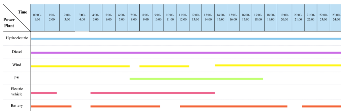
شکل ۱۱. توان خروجی واحدهای درگیر در نیروگاه مجازی از روش ELM-GA .
