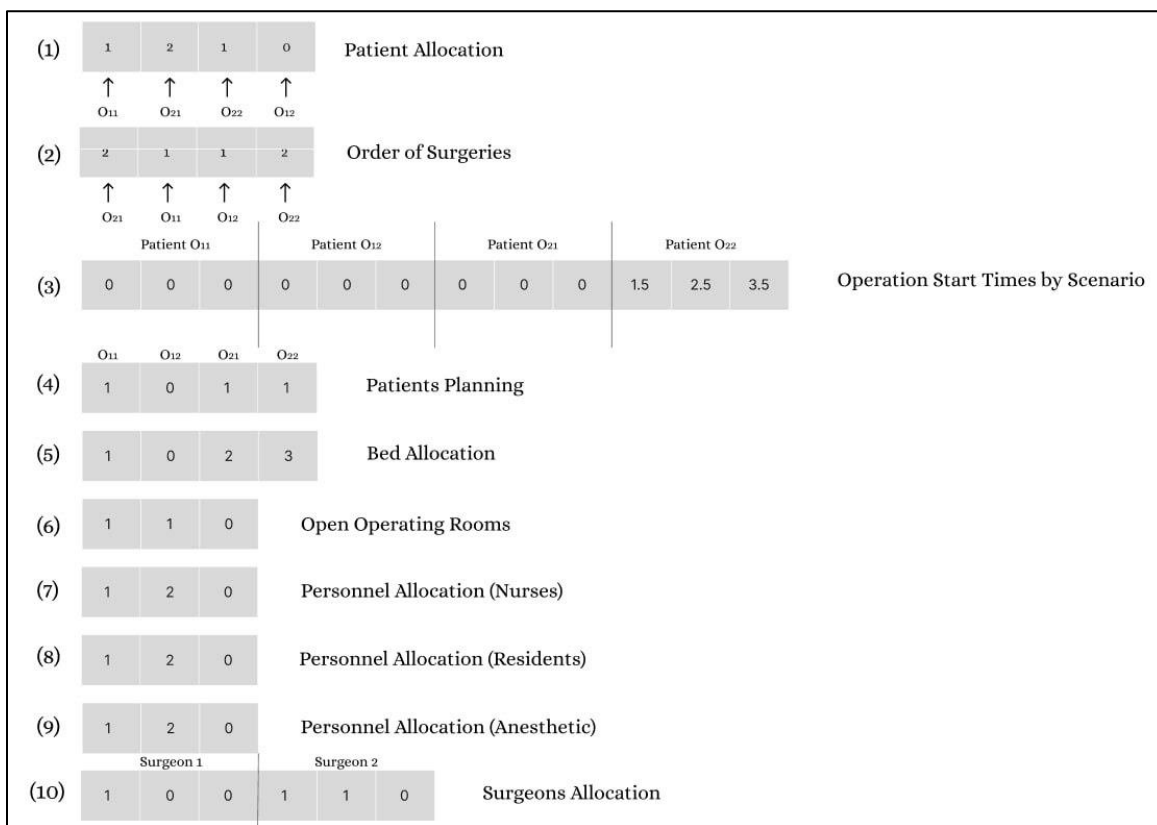
شکل ۱. نمایش کروموزم در الگوریتم ژنتیک (Chromosome representation in genetic algorithm)
