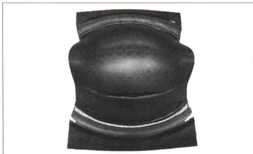
شکل ۲. نمایش تبدیل دایره‌های حک شده روی نمونه به بیضی پس از انجام آزمایش (نمونه ورق با عرض 100\text{ mm} ).
