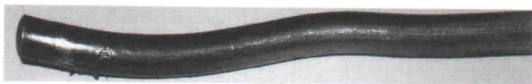
شکل ۱۷. اعوجاج در میله‌ی پودری اکستروژد شده در دمای 600^{\circ}\text{C} و سرعت 150 میلی‌متر بر دقیقه.
